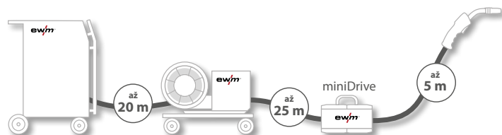
Příklad systému: Dekompaktní svařovací přístroj + podavač drátu + miniDrive
